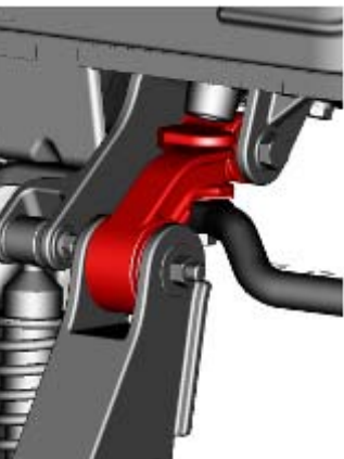
H476 – рычаг передней подвески кабины (7C46-5402-AG/BG)
