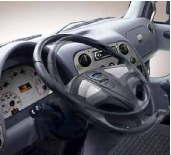
Регулируемая по вылету и углу наклона рулевая колонка
