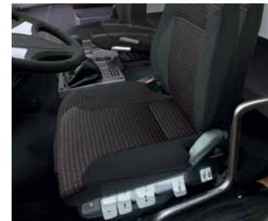
Пневматически регулируемое сиденье водителя
